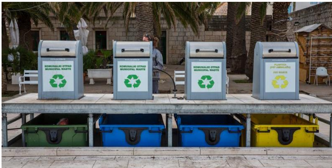
Рисунок 36. Пример подземного хранилища контейнеров для мусора.
